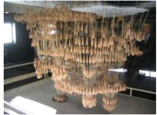
Figure 12: Antonio Gaudi. (1889). Sagrada Família . Hanging chain model.
